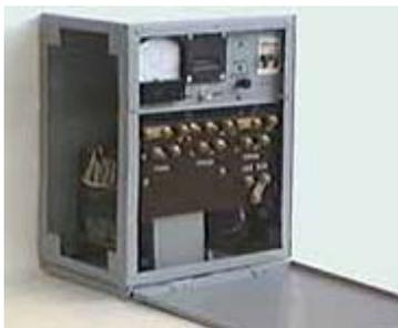
При эксплуатации нефтяных скважин и насосного оборудования всегда существует опасность возникновения коррозии, которая значительно уменьшает его срок службы. В этих случаях целесообразно использовать дополнительные методы защиты помимо традиционного антикоррозийного покрытия. Наиболее эффективным и экономичным методом является установка оборудования для катодной защиты сооружений.
