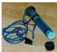
Предназначены для измерения разности потенциалов и градиентов потенциала при проведении электрометрических работ на подземных сооружениях
