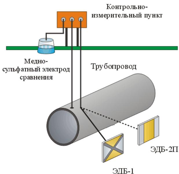
Электрод длительного действия биметаллический типа **ЭДБ** используется в качестве датчика при измерениях разности потенциалов между металлическими подземными сооружениями и землей для управления станцией катодной защиты в автоматическом режиме.
