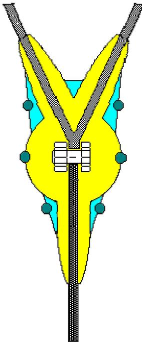
Предназначена для высоконадежной герметизации контактного соединения электрических цепей напряжением до 100В в системах катодной защиты металлических сооружений от коррозии.
